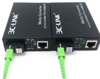
Gambar 3.5. Contoh media converter sepasang.
